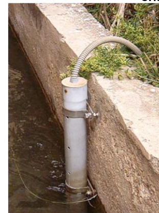
Sensor piezorrestivo instalado en acequia (Perona, Mula) - CHS
