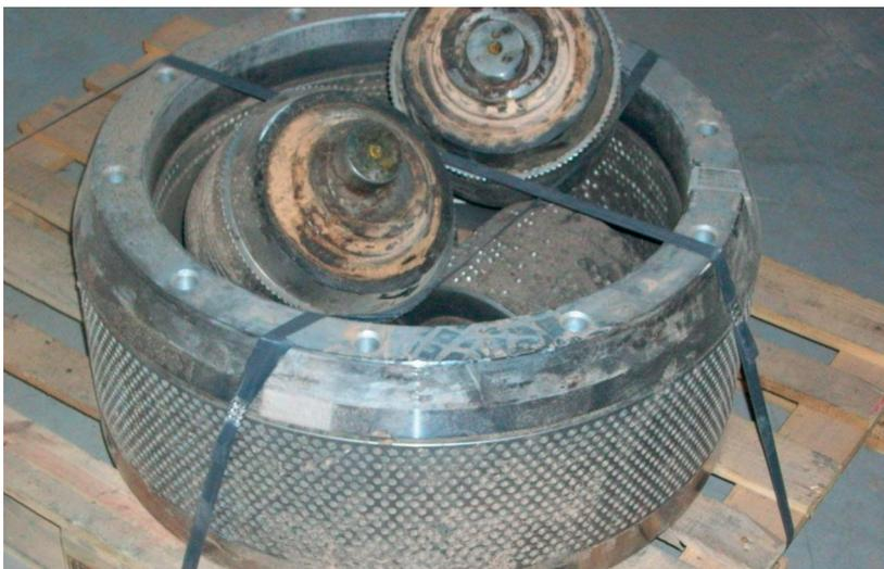
*Rodillos para el mecanismo de pelletizado*
